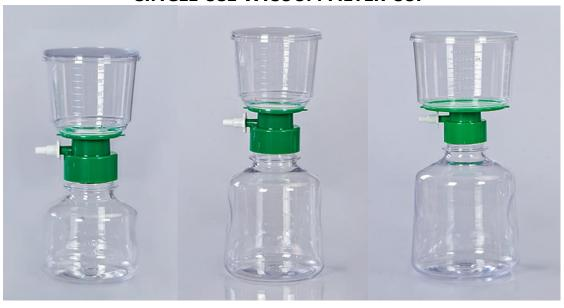
**Descrizione**: Sistema filtrante sottovuoto monouso, materiale filtrante PES.
